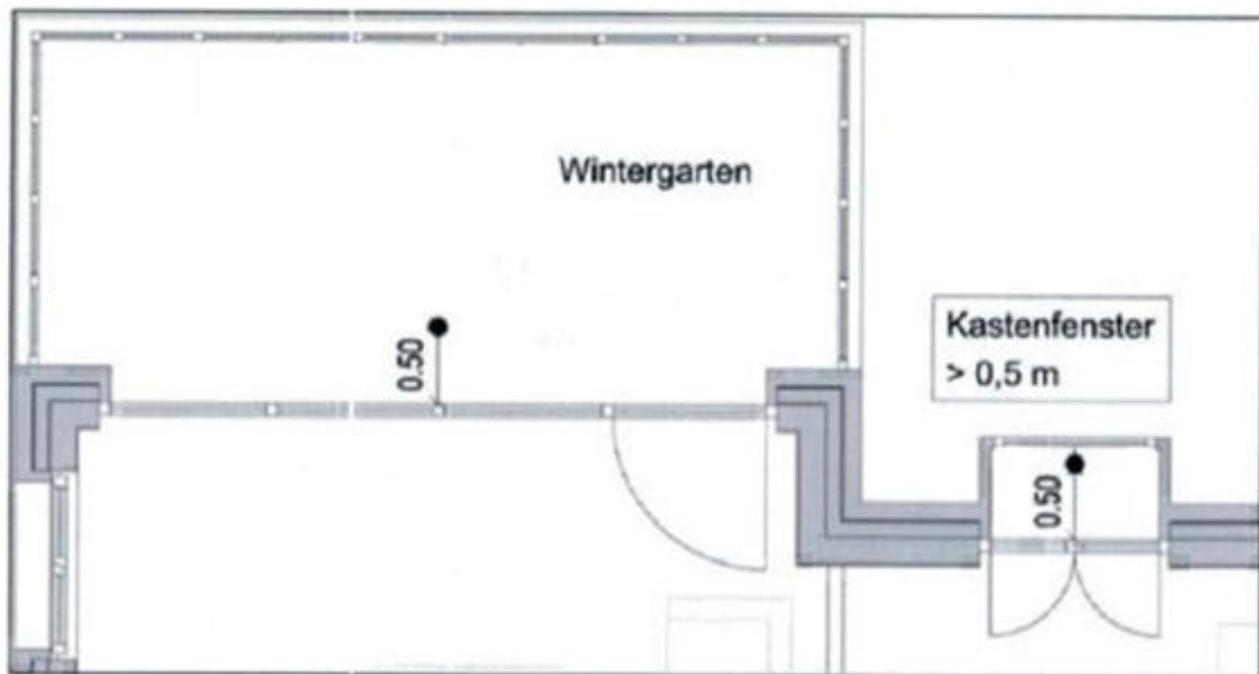
**Abbildung 1:** Beispiel: teilverglaste Balkone, teilverglaste Loggien oder Kastenfenster die über eine Teilverglasung vor dem inneren Fenster des schutzbedürftigen Aufenthaltsraumes verfügen, die nicht geöffnet oder entfernt werden kann und so dimensioniert ist, dass 0,5 m vor dem geöffneten inneren Fenster bzw. der geöffneten inneren Fenstertüre gemessen werden kann
