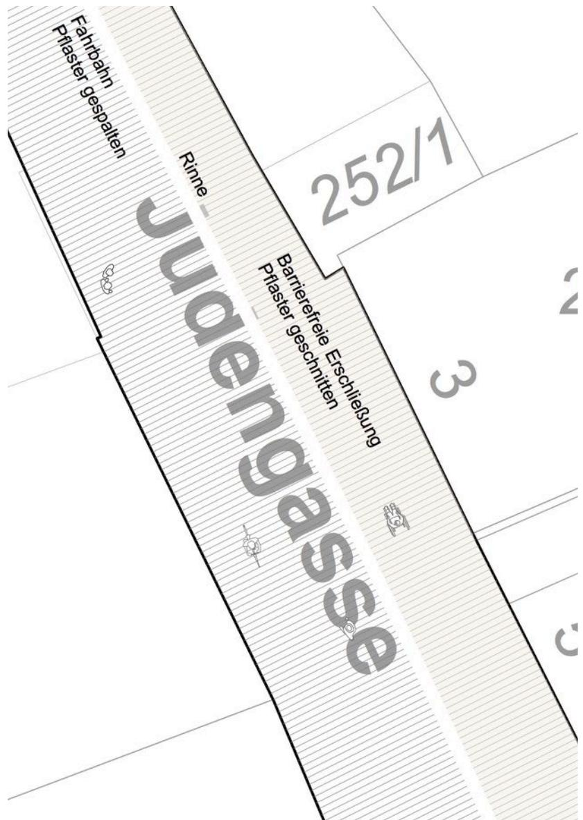
Planskizze Judengasse, M 1:200: Die durch die Rinne gegebene Oberflächengliederung wird beibehalten. Zwischen Rinne und Gebäude wird durch Austausch des Oberflächenbelages durch gesägtes Material eine gestalterisch einwandfreie, barrierefreie Begeh- und Berollbarkeit hergestellt.
