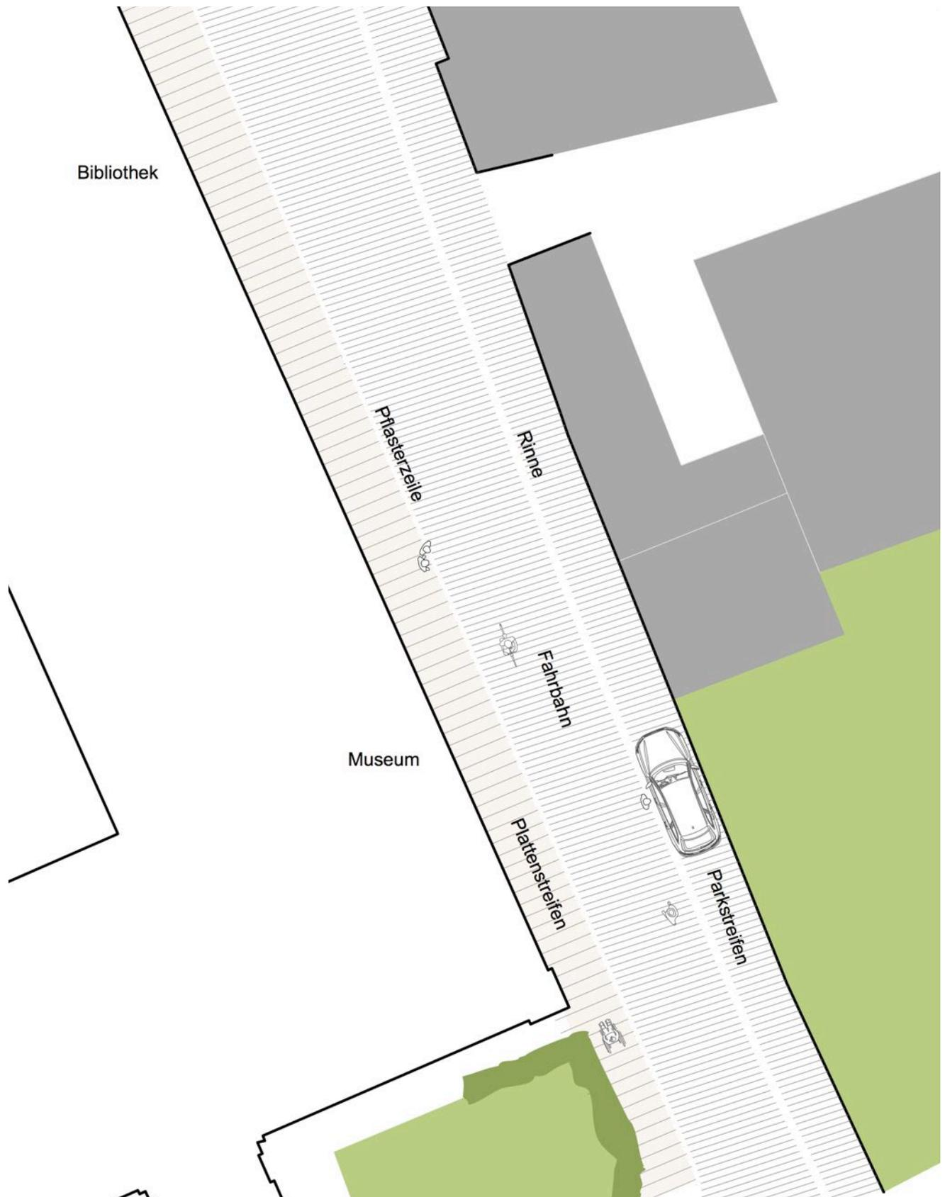
Planskizze M 1:200: Die Bereiche unmittelbar am Museumsgebäude, die durch die bestehende Rinne von der Fahrbahn separiert sind, können zu gestalterisch ansprechenden und gut bege- und berollbaren Plattenstreifen umgebaut werden.
